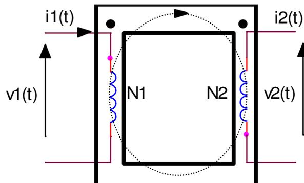
On alimente en alternatif le primaire par une tension sinusoïdal  $V_1$ , un flux forcé s'établit dans le circuit magnétique, le secondaire est alors soumis à une variation de flux donc d'après la loi de Lenz sera le siège d'une FEM induit.
