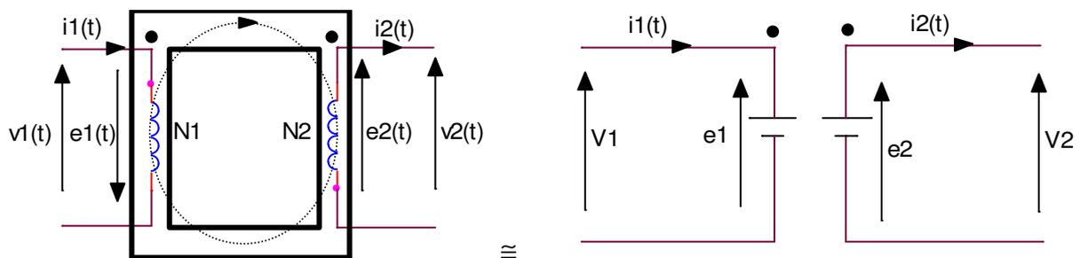
L'étoile représente le couplage magnétique du circuit, c'est-à-dire le sens des flux créée par les enroulements.
