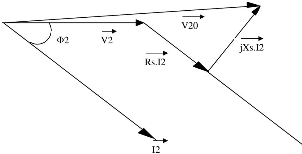
Par approximation on peut écrire :  $\Delta V_2 = R_s.I_2.\cos \varphi_2 + X_s.I_2.\sin \varphi_2$
