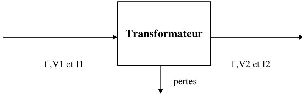
Utiliser en sortie de centrale, le transformateur élève la tension pour transporter sur de grande distance la puissance en minimisant les pertes dans les lignes (220kV à 700kV), puis des transformateurs abaissent la tension pour les utilisateurs industriels ou particuliers( en France 27 millions).
