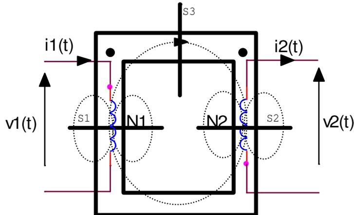
Flux embrassé par les différentes sections  $S_1$ ,  $S_2$  et  $S_3$  :
